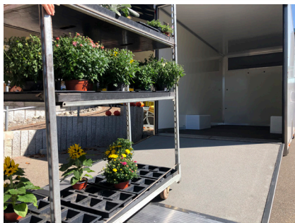
Ladekante ab 41 cm --> einfaches Be- und Entladen
