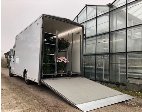
Breite hydr. oder mechanische Heckrampe
